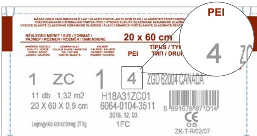
2. ábra: Kopásállóság jelölése kerámia burkolólap dobozán
